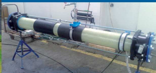
System Process Phoenix Double Jacket podczas wykonania próby ciśnienia
