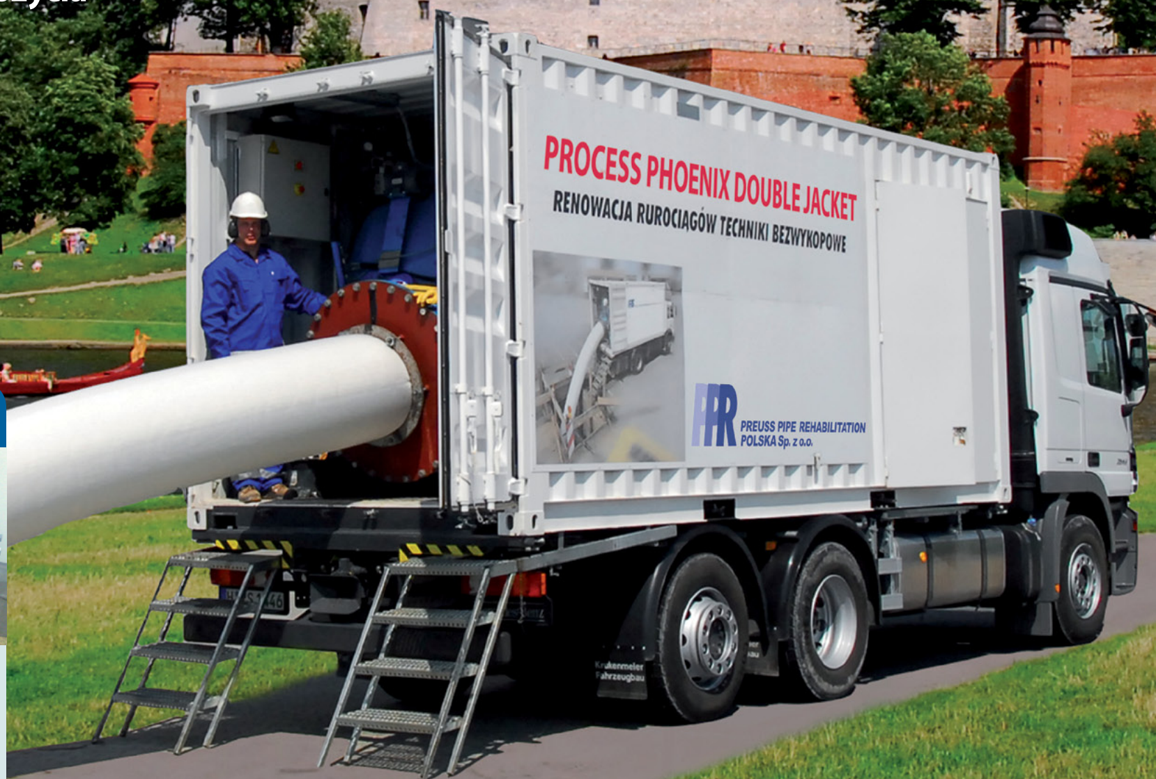
System Process Phoenix Double Jacket podczas wykonania próby ciśnienia
